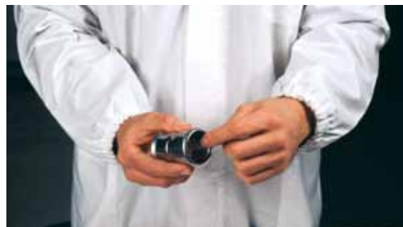
Obr. 20 – Kontrola těsnícího kroužku
