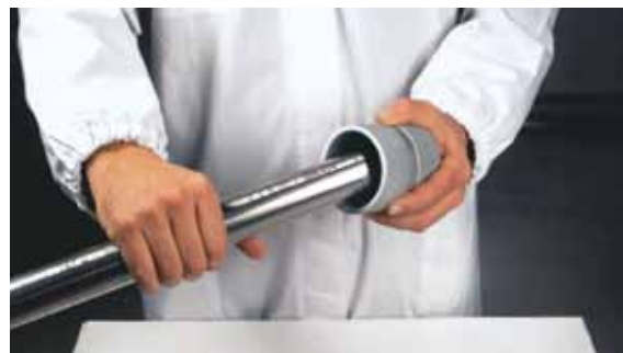
Obr. 16 – Odjehlení potrubní trubky
