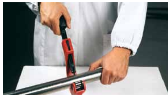
Obr. 15 – Zkrácení potrubní trubky
