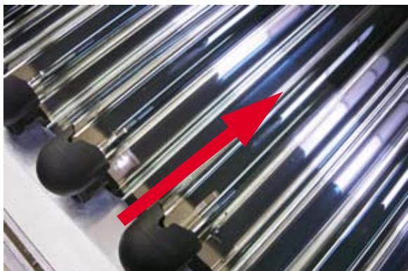
**1.** posunout (zatlačit) vakuovou trubici o cca 40 mm směrem nahoru do sběrné skříně kolektoru
