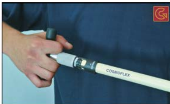
Kalibrace a odhrotování čela trubky - otáčením ve směru hodinových ručiček.
