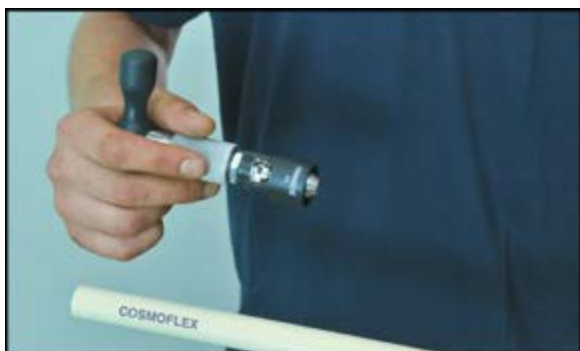
Vložení odhrotovacího nástavce příslušného průměru 16 - 32 mm do univerzálního držáku.
