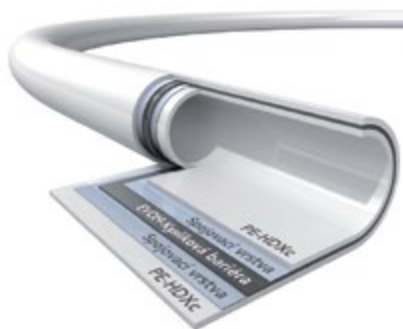
COSMO vícevrstvé potrubí PE-Xcellent 17x2 mm zesíťovaný polyetylén s kyslíkovou bariérou EVOH DIN-CERTCO 3V366
