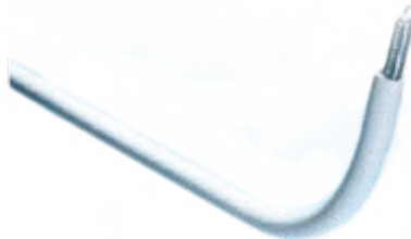
Ručně tvarovaný oblouk pomocí ohýbací pružiny
